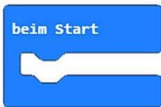
Alle Blöcke (= Programme) innerhalb der **Start-Klammer** werden nur einmal beim **Start** ausgeführt.
