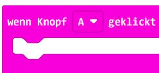
Bei einem Klick auf **Knopf A** des Micro:bit wird der Programmblock innerhalb der Klammer ausgeführt. Mit der Pfeilauswahl kann man weitere Knöpfe aktivieren: **B** und **A+B**
