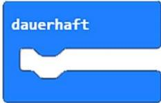
Blöcke innerhalb dieser Klammer werden vom Micro:bit so lange als **Endlosschleife** ausgeführt, bis man den Strom abschaltet.
